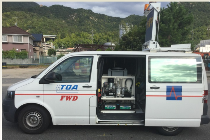
載荷板・たわみセンサー等で舗装状態を評価
