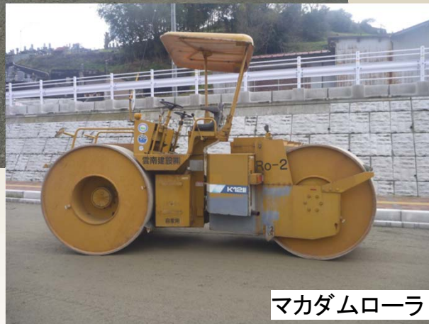
マカダムローラによる締固め
